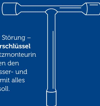
Ob Wartung oder Störung – mit dem **Schieberschlüssel** regelt die Rohrnetzmonteurin im Handumdrehen den Durchfluss in Wasser- und Gasleitungen. Damit alles so fliesst, wie es soll.
